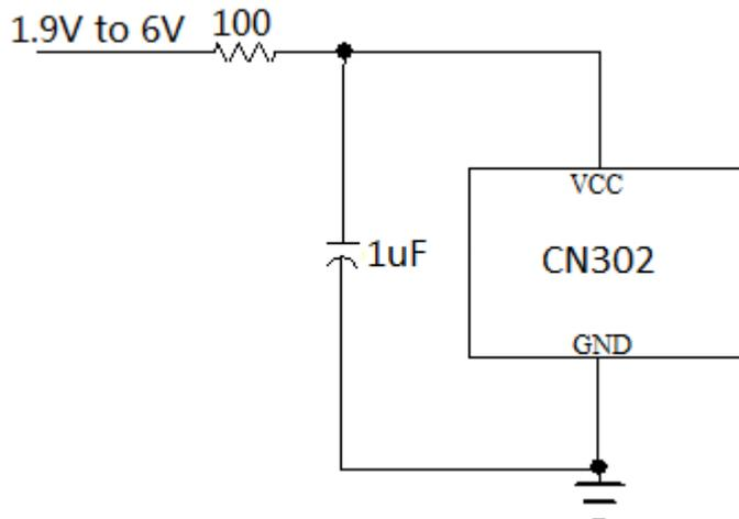
Figure 8 An RC Filter For CN302
